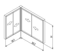
W 1、W 2:内窓サッシ幅 W A、W B:内窓サッシ製作用幅 @:コーナー方立部材取付必要寸法 ®:コーナー方立部材取付必要寸法
