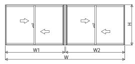
W 1、W 2:内窓サッシ幅 W A、W B:内窓サッシ製作用幅 ④:内窓方立取付必要寸法
