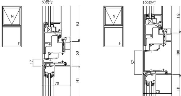
(28) 突出し窓(カムラッチ・露出・すべり出し/FIX窓(内押縁))
