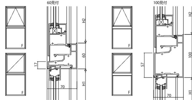
(30) 外開き窓・たてすべり出し窓/FIX窓(内押縁)
