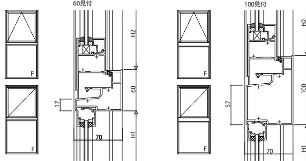
(29) 突出し窓(カムラッチ・露出)・すべり出し窓/FIX窓(外押縁)
