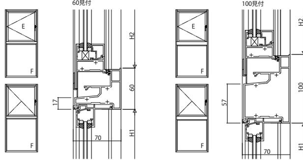
(32) たてすべり出し窓(オペレーターハンドル・スリット換気)/FIX窓(内押縁)
