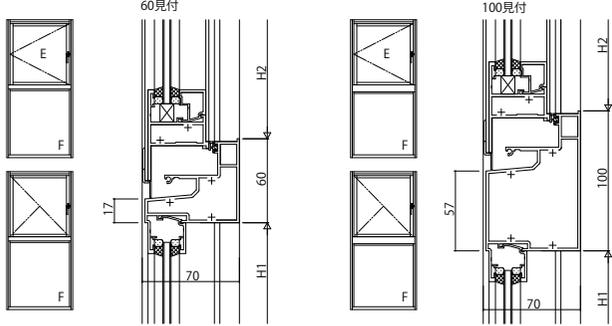
(31) 外開き窓・たてすべり出し窓/FIX窓(外押縁)
