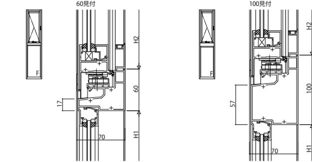
(33) たてすべり出し窓(オペレーターハンドル・スリット換気)/FIX窓(外押縁)
