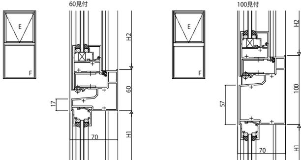
(25) 外倒し窓/FIX窓(外押縁)
