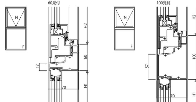
(27) 内倒し窓/FIX窓(外押縁)
