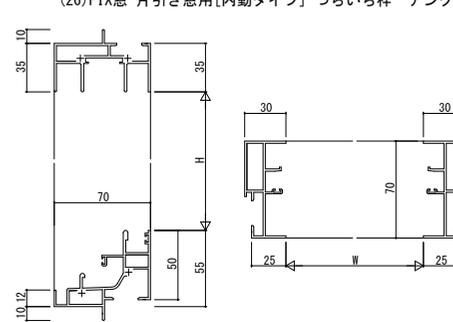
(27) FIX窓 片引き窓用 [内動タイプ] 自立 (つらいち枠) アングルなし
