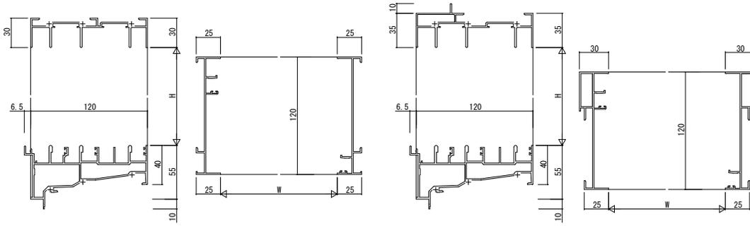
(22) FIX窓 片引き窓用 [内動タイプ] RC枠 アングル付
