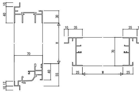
(26) FIX窓 片引き窓用 [内動タイプ] つらいち枠 アングルなし
