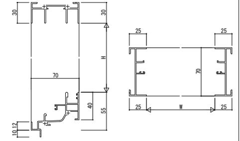
(24) FIX窓 片引き窓用 [内動タイプ] ALC枠 アングル付
