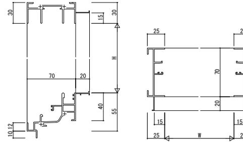
(23) FIX窓 片引き窓用 [内動タイプ] RC枠 アングルなし
