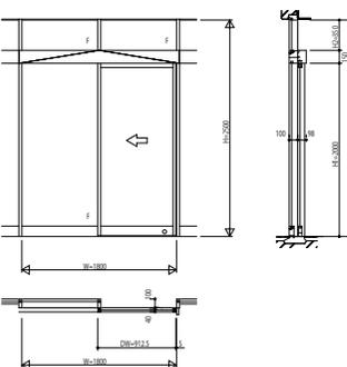
自動ドア【一般スライド】エンジン外付引分けFIX段窓
