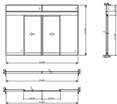
自動ドア【一般スライド】エンジン外付片引きFIX段窓
