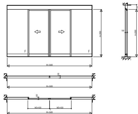
自動ドア【一般スライド】エンジン内蔵片引きFIX段窓
