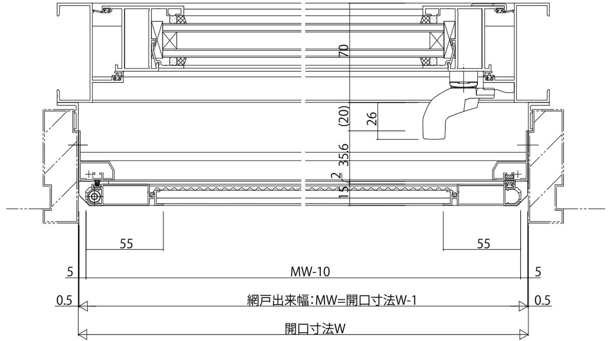
網戸出来幅: MW=開口寸法W-1
