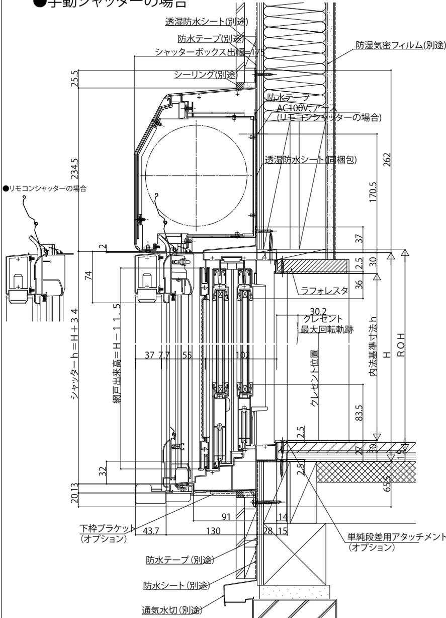
※(床構造用合板の厚さ)+(床材の厚さ)は 43mmを超えないようにしてください。
