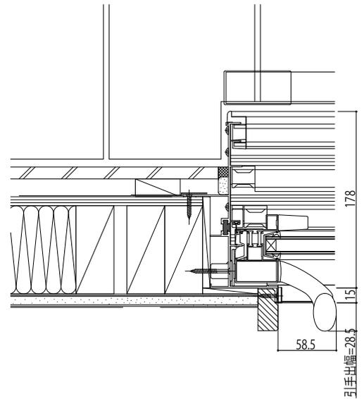
※(床構造用合板の厚さ)+(床材の厚さ)は、30mmを超えないようにしてください。
