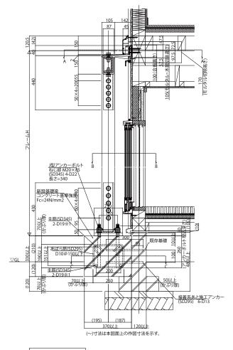
●アンカーボルト詳細図 |型アンカーボル (SD343) D22 (SD34
