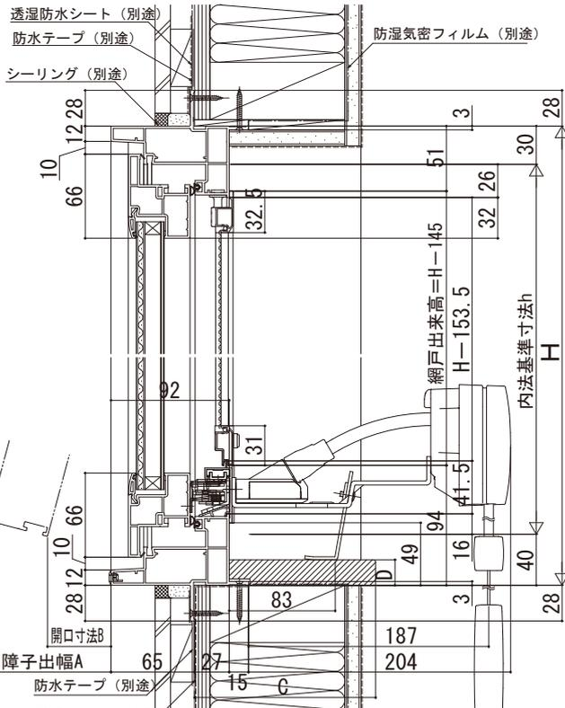
開き角度、障子出幅、開口寸法 単位 (mm)
