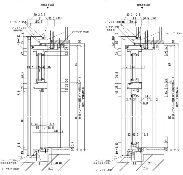
●片袖FIX・片袖FIX親子枠 ランマ部 D4仕様 (KーK'断面)●両袖FIX枠 ランマ部 D4仕様 (LーL'断面)
