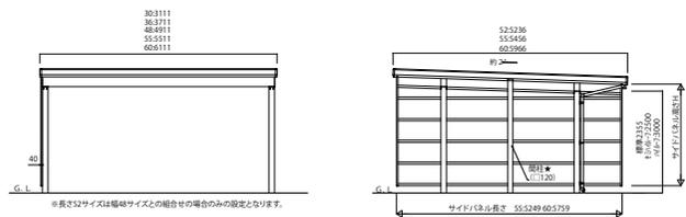
基本セット用サイドパネル(波板タイプ)片側3本柱に取付ける場合
