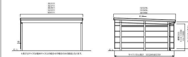
基本セット用サイドパネル(波板タイプ)片側4本柱に取付ける場合
