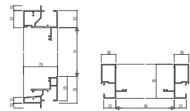
(15) 可動窓※1・外創し窓【排煙窓・露出オペレーター仕様】
