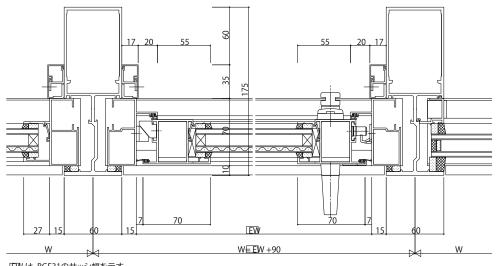
IEW は、BGE31のサッシ幅を示す IEH は、BGE31のサッシ高さを示す
