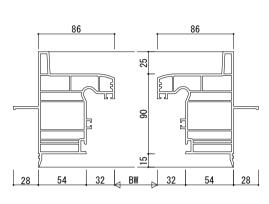
(2) 内倒し窓・内開き窓 つらいち枠 アングルなし
