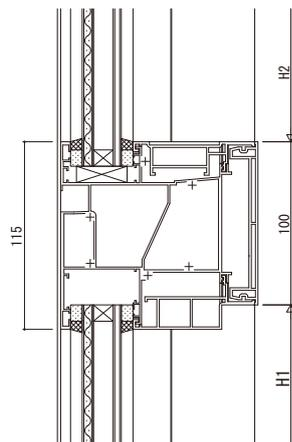
■たてすべり出し窓・突出し窓／FIX窓（内押縁）
