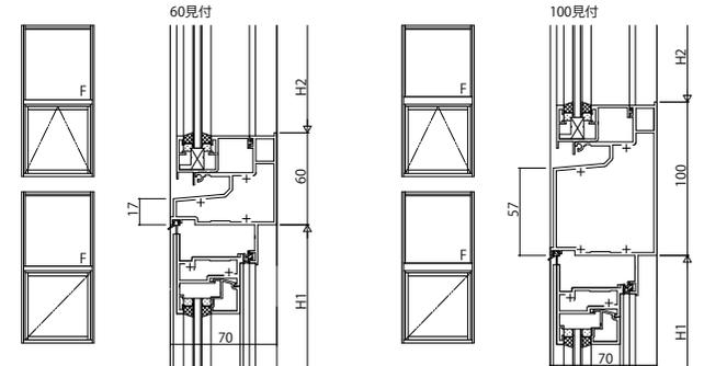
(4 7) 突出し窓(カムラッチ・露出)・すべり出し窓／突出し窓(カムラッチ・露出)・すべり出し窓
