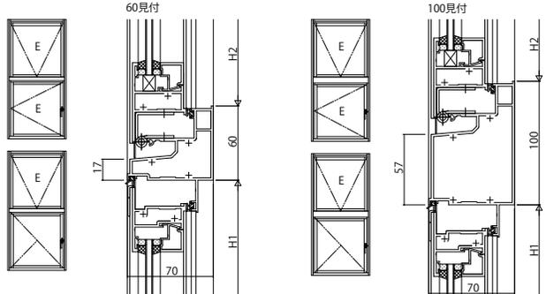
(5 1) 内倒し窓／外開き窓・たてすべり出し窓
