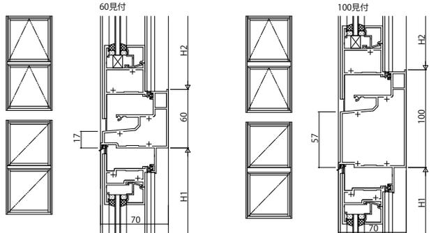
(4 8) 固定がらり(非脱着)／突出し窓・すべり出し窓
