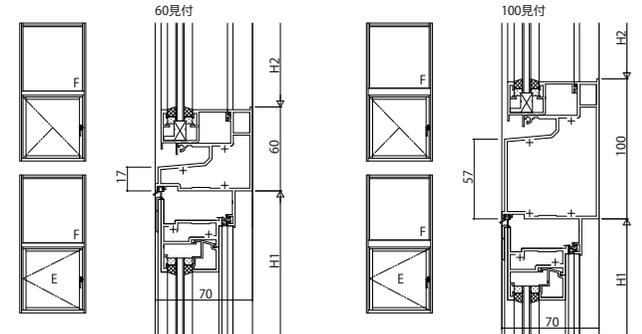
(5 0) 外倒し窓／外開き窓・たてすべり出し窓
