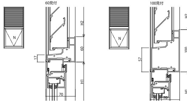
(4 6) F I X窓(内押縁・外押縁)／突出し窓・すべり出し窓
