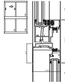
(7)外倒し(排煙錠・隠ぺいオペレーター仕様)／8片引き／F I X
