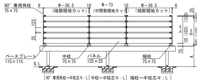
※W寸法は、現地カット前の両端キャップを含むパネル寸法です。
