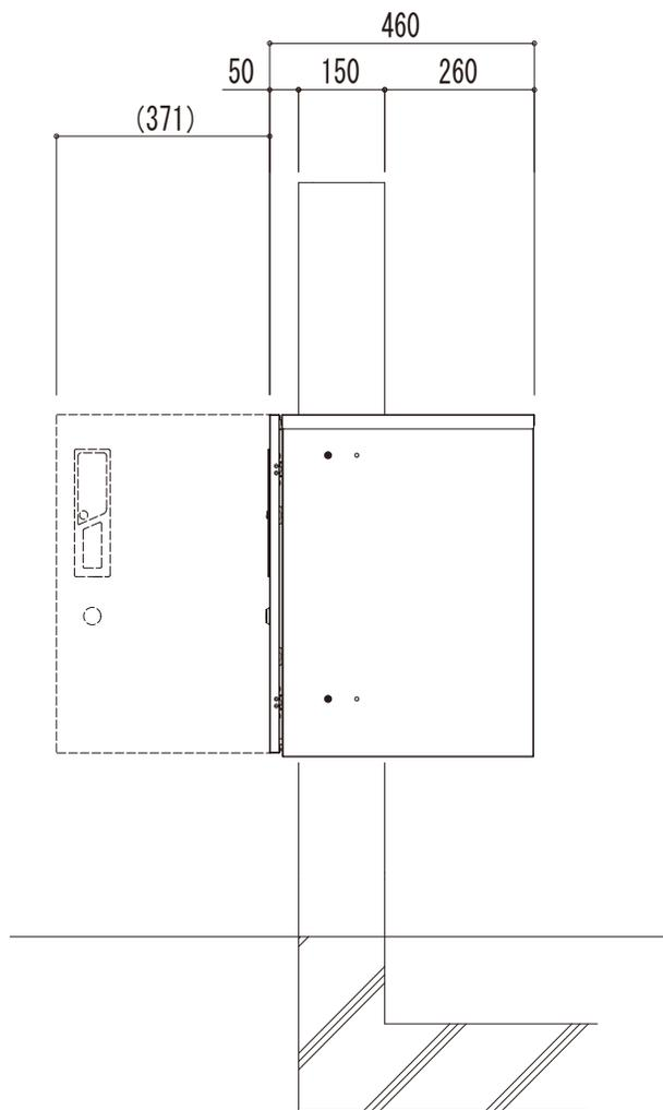
(注) 適切な開口補強筋を設けてください。
