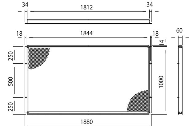
パネル(吸音タイプ H1m) 詳細図 (1/25)
