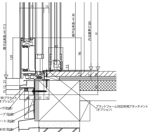
※(床構造用合板の厚さ)+(床材の厚さ)は、4.3mmを超えないようにしてください。
