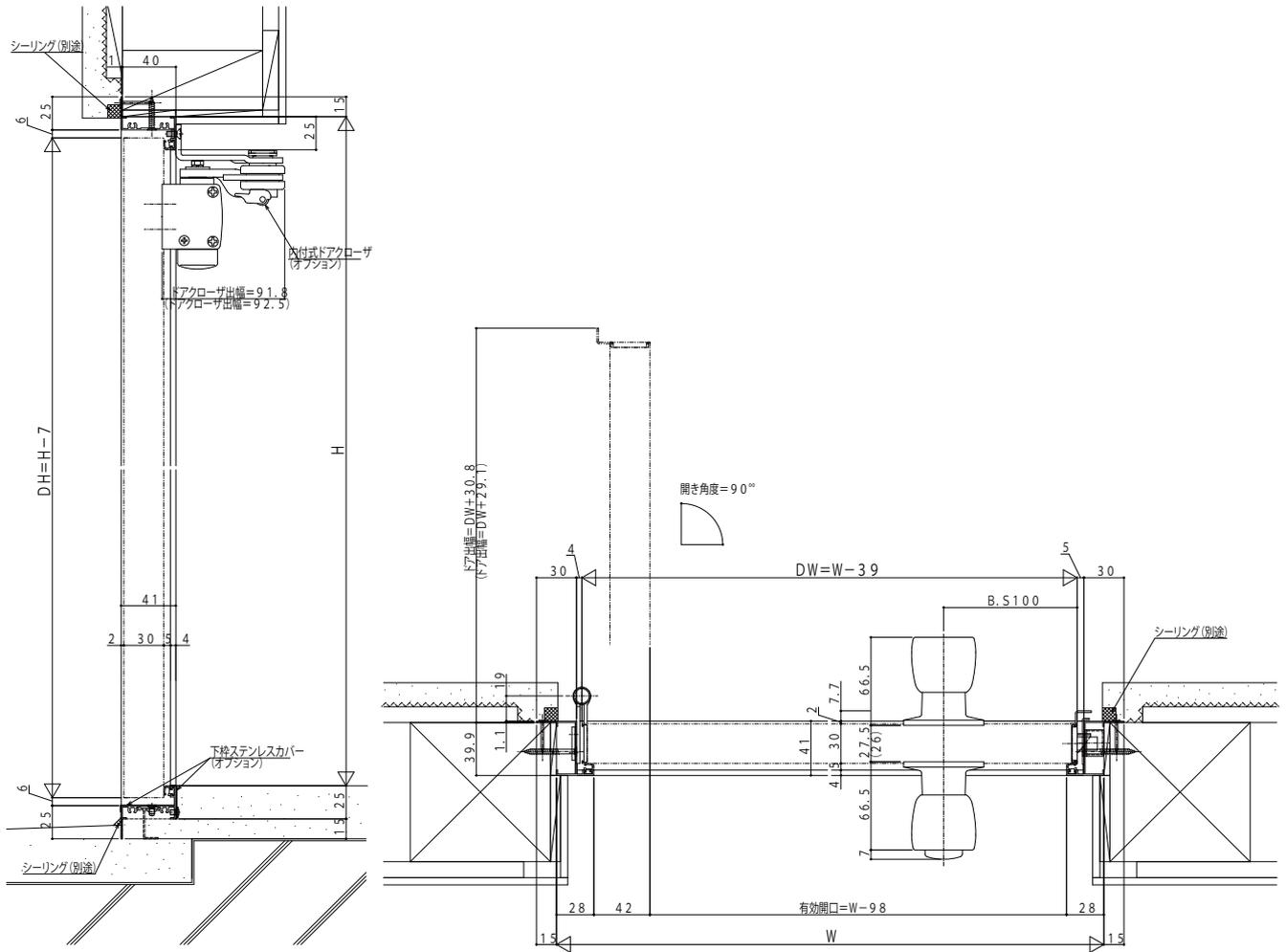
●ランマFIX(内付式ドアクローザ(オプション)取付け例)
