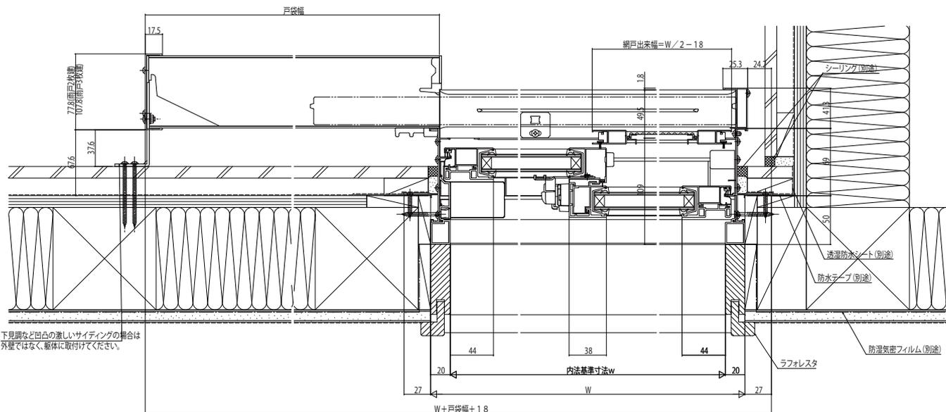
下見脚など凹凸の激しいサイディングの場合は外壁ではなく、躯体に取付けてください。
