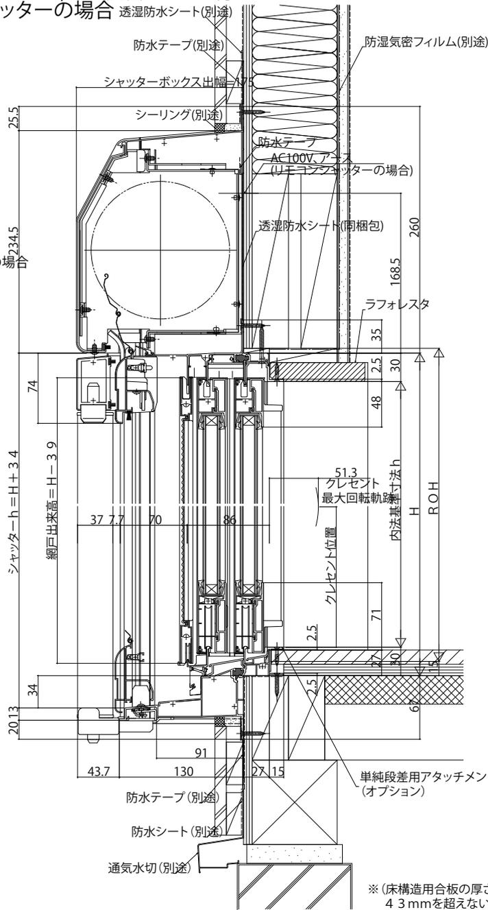
※(床構造用合板の厚さ)+(床材の厚さ)は、43mmを超えないようにしてください。
