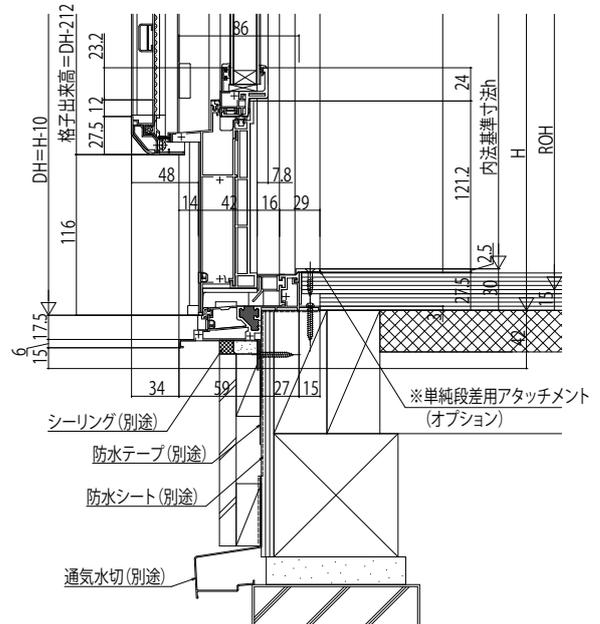
※ (床構造用合板の厚さ)+(床材の厚さ)は 43mmを超えないようにしてください。
