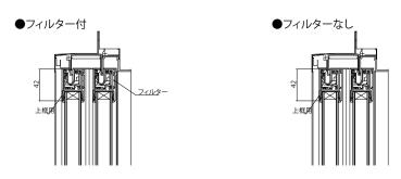
2枚建 H03~13,W>1,900/H=15/H=18·20,W>1,900 4枚建 H03~13,W>3,810/H=15/H=18·20,W>3,810
