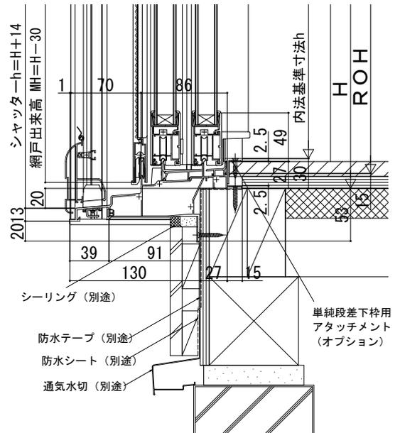
※ (床構造用合板の厚さ) + (床材の厚さ) は、43mmを超えないようにしてください。
