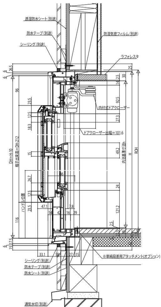
※(床構造用合板の厚さ)+(床材の厚さ)は、43mmを超えないようにしてください。
