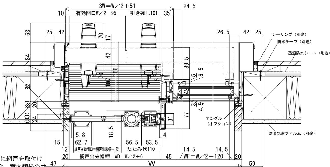
※1 袖付枠に網戸を取付ける場合、室内額縁の寸法は80mm以上確保してください。
