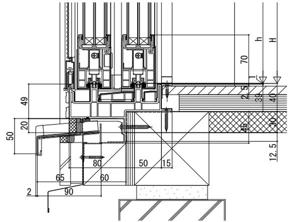
水切の裏側に水が浸入することがあるため、躯体の防水処理および排水経路の確保を行ってください。
