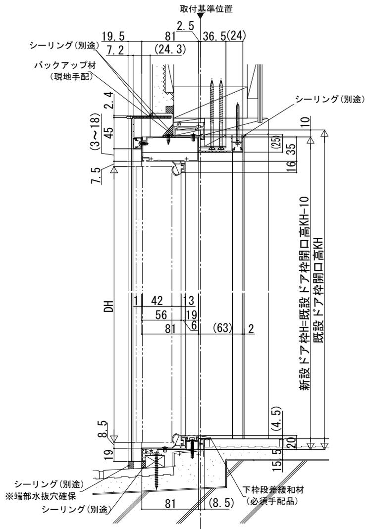
※「下枠フラット材納まり」「下枠幅木納まり」
