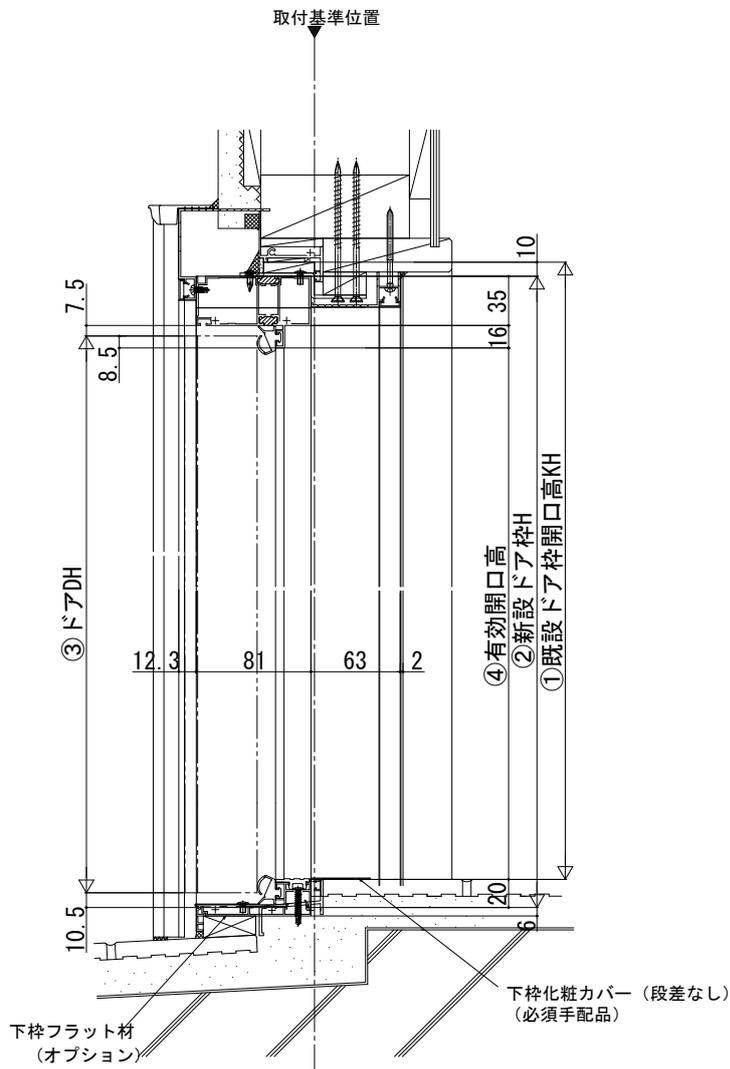
下枠はつり納まりの「既設ドア枠開口高」は、その他納まりの「既設ドア枠開口高KH」と基準位置が異なります。
