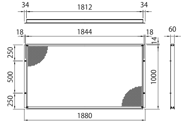
パネル(吸音タイプ H1m)詳細図(1/25)
