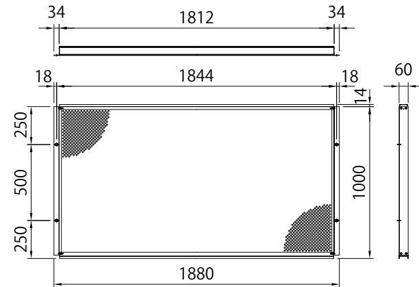
パネル (吸音タイプ H1m) 詳細図 (1/25)
