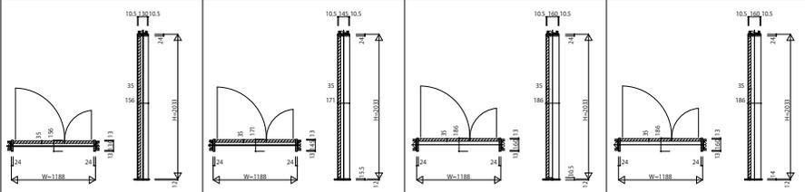
ケーシングタイプ4方枠 枠見込み140/段沓槽(シート) / ケーシングタイプ3方枠 枠見込み140/埋込沓槽(アルミ)
